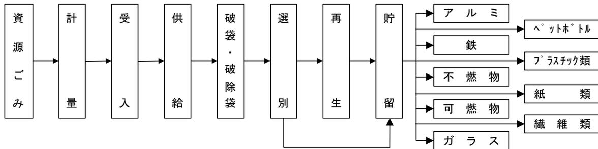
図 5-6 資源化施設の処理フロー
