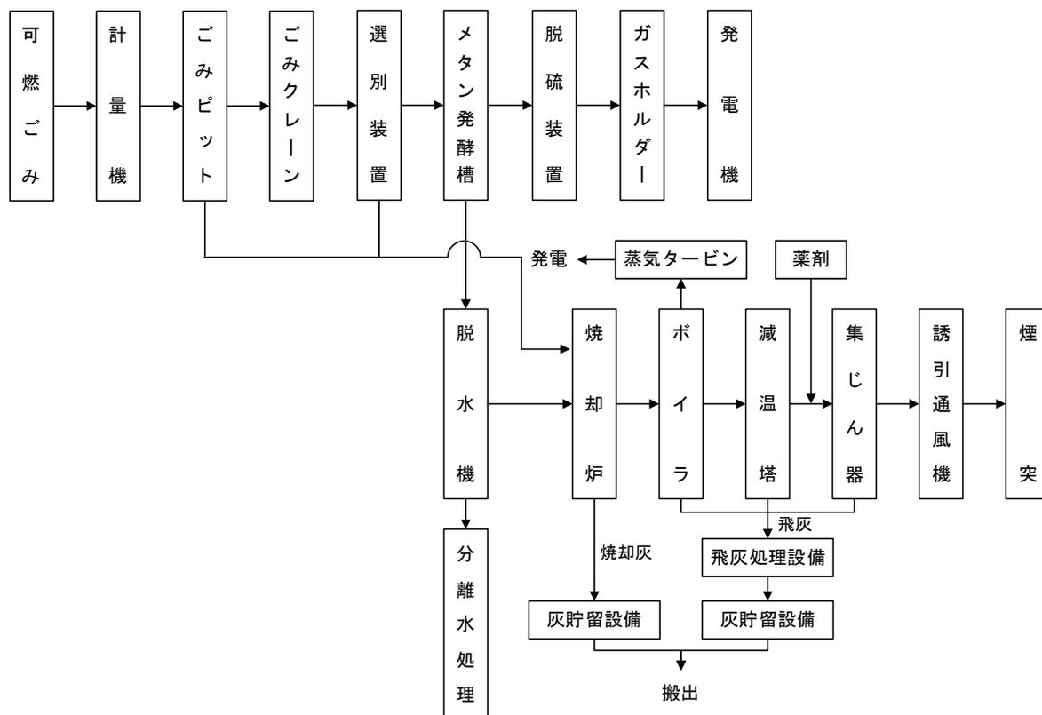
図 5-3 燃料化：バイオガス化+焼却（コンバインド方式）の処理フロー
