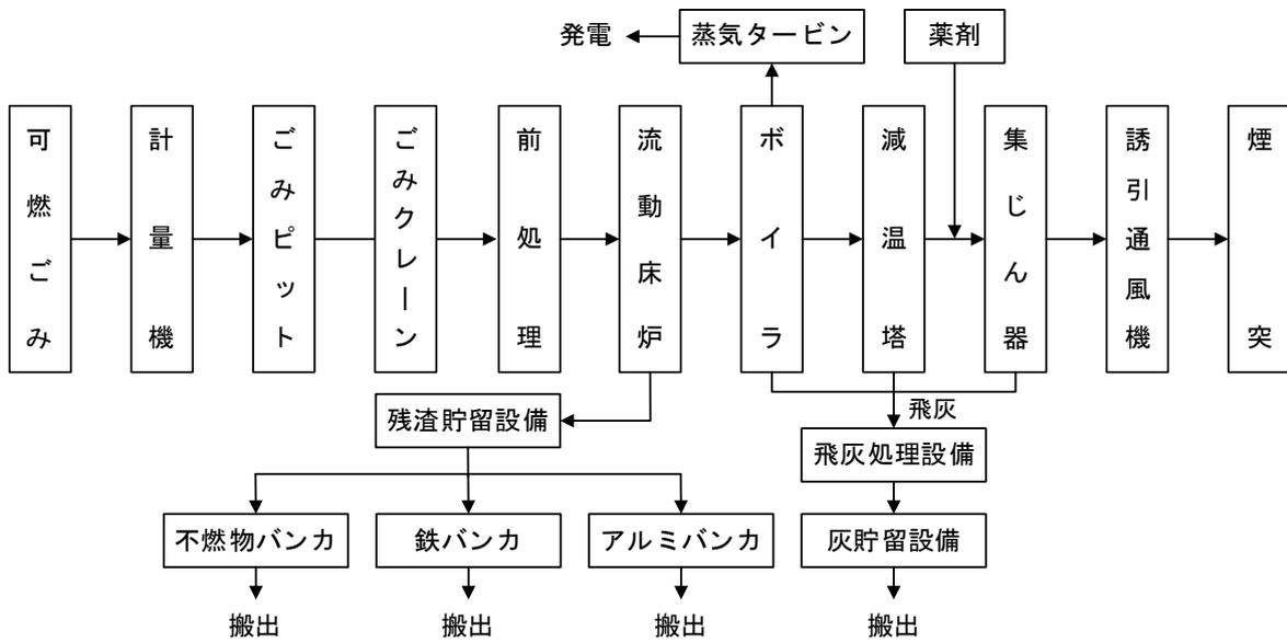
図 5-2 焼却：流動床式の処理フロー
