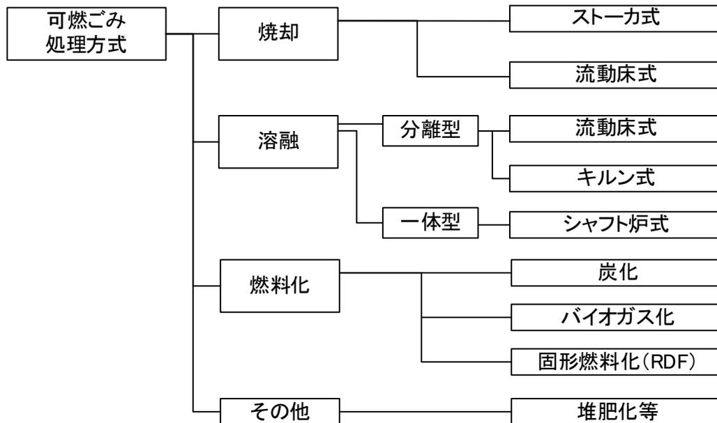
図 1-16 一般的な可燃ごみ処理方式
