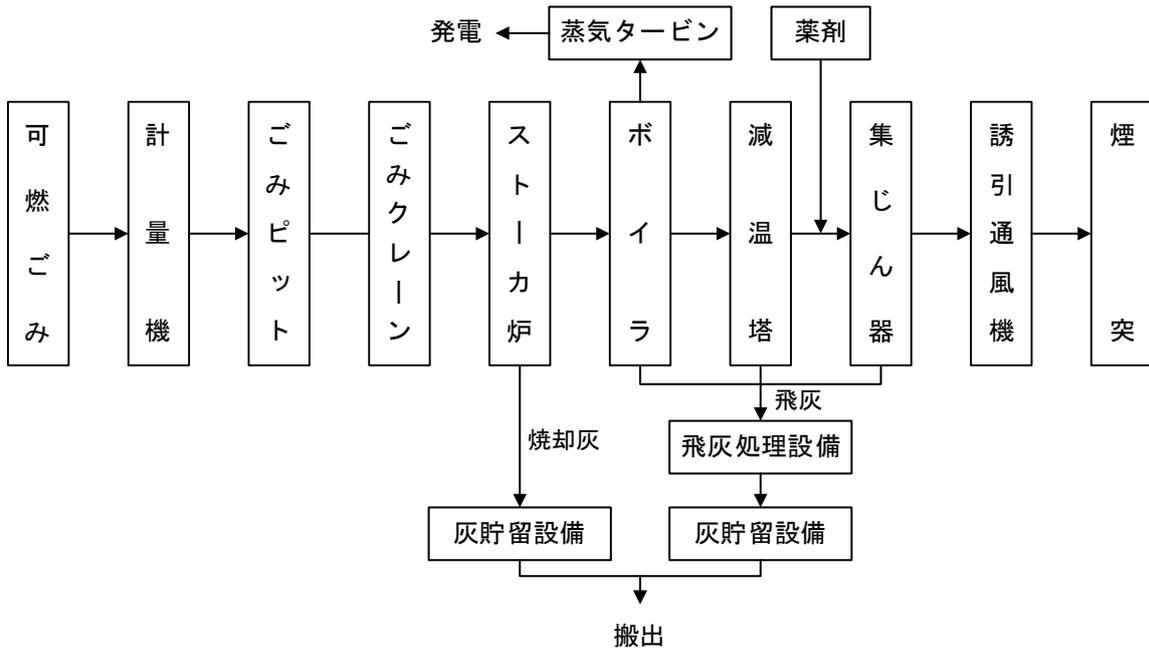
図 5-1 焼却：ストーカ式の処理フロー
